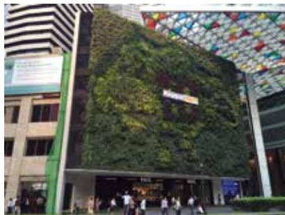
Mur végétalisé proche d'une place passante (rôle d'isolation acoustique et thermique), Singapour.
