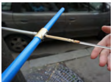
Carotte extraite du tronc à l'aide d'une tarière de Pressler.
