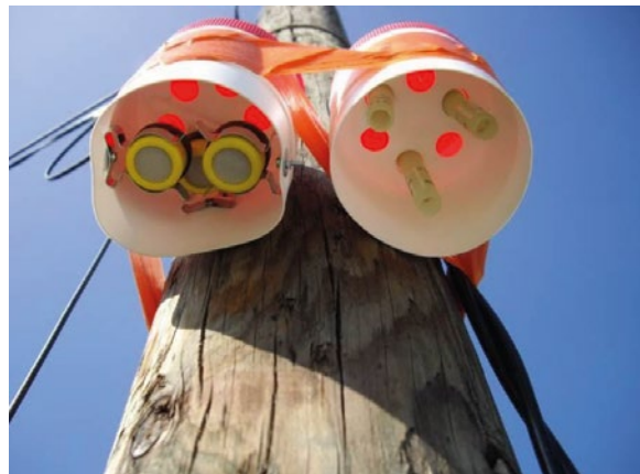
Capteurs de qualité de l'air - dispositif de mesures passives
